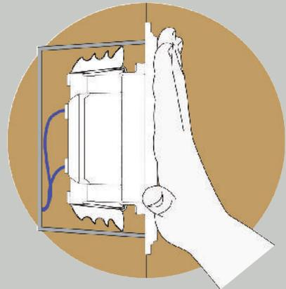
Зубцы сильно упираются в стенки и предотвращают выпадение механизма
