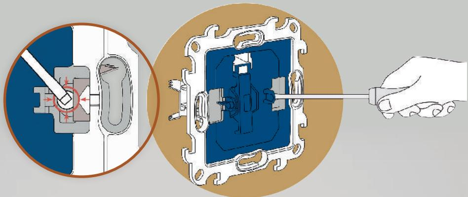
Привинчивание не требуется, достаточно надавить в отверстия. Закрепление важно для правильной установки
